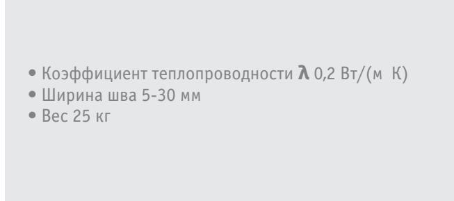
Теплоизоляционная кладочная смесь ТМ «HAGAST» TERMO ST LT-200 предназначена для монтажа конструкционных поризованных керамических блоков с низкой теплопроводностью, легких теплоизоляционных блоков из ячеистого бетона и на основе заполнителя, рядовой кладки пустотелого кирпича. Также используется для заполнения технологических и ремонтных пустот и щелей при проведении наружных и внутренних работ в зданиях и сооружениях различного назначения.
